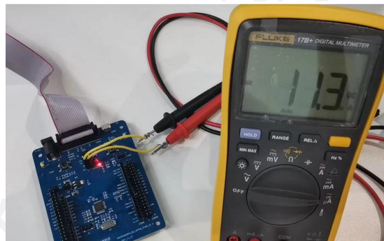
图 11 CS32F03x-RA 开发板 Deepsleep 电流测量
